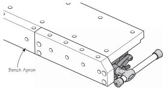
Figure 10: Installing the apron.
